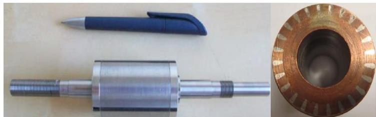
10kW, 80kr/min叠片转子(Cummins)
