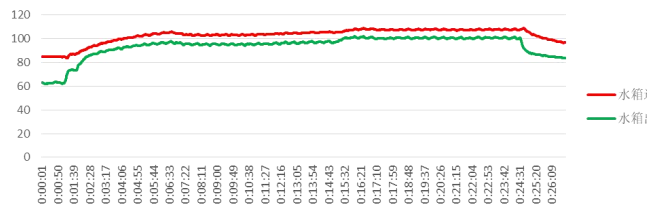
图 13 爬坡工况试验测量水箱进出口温度
