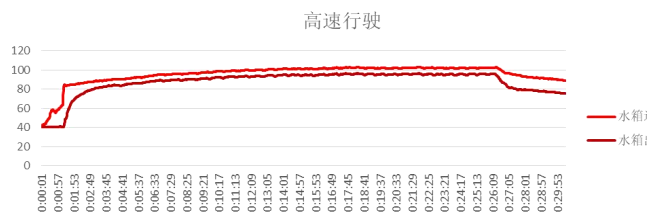
图 12 高速工况试验测量水箱进出口温度
