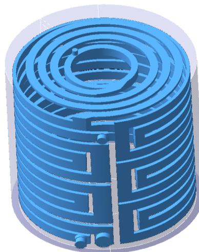
图 8 优化后水套三维图
