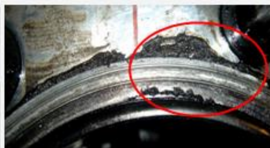
气缸垫孔口烧蚀
