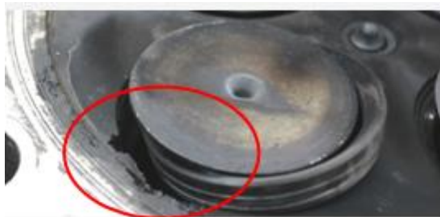
缸盖烧蚀与气门座圈脱落
