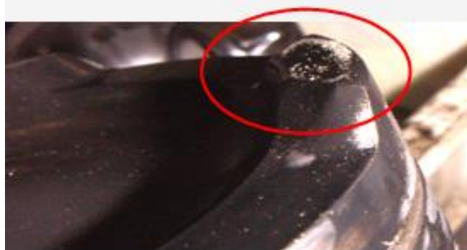
缸盖烧蚀与气门座圈脱落
