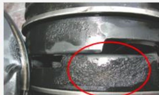
活塞火力岸与避阀坑烧蚀
