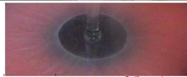
膜态沸腾区域 预热~核态沸腾区域 膜态沸腾区域
