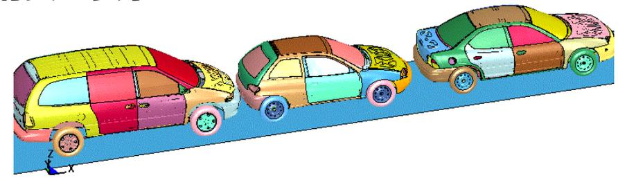
➤ CAE分析：在电脑中模拟汽车碰撞过程，通过分析结果更改设计，如此反复若干次，直到符合碰撞的安全要求
