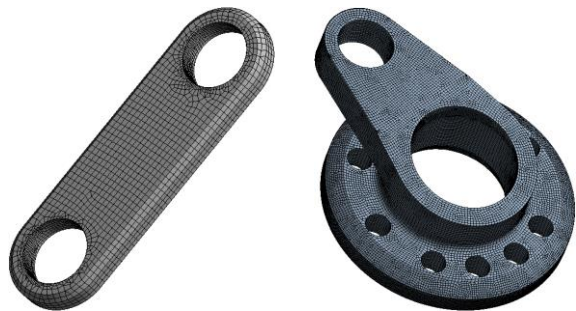
图 8 连杆有限元网格 图 9 拐臂有限元网格结果
