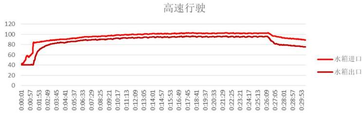
图 12 高速工况试验测量水箱进出口温度
