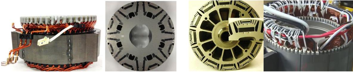
(a) 第 4 代 Prius 主驱动电机转子冲片与定子结构
