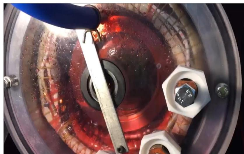
试验中油的喷射流动 @ 90C
